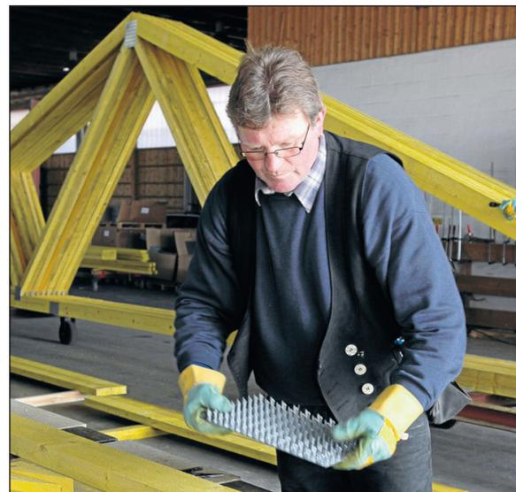
**Mit Nagelplatten** werden die einzelnen Holzelemente zu einem – der Name sagt es – Nagelplattenbinder verbunden.
