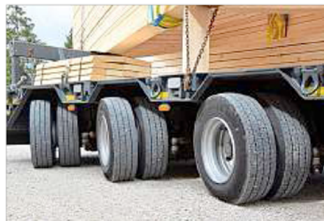
Die Schwertransporte werden von Disponent Herbert Goß (v.l.) und Firmenchef Christian Hierl auf die Reise geschickt. Die Räder können um bis zu 60 Grad gedreht werden. Fotos: Rast, Ehrlich
