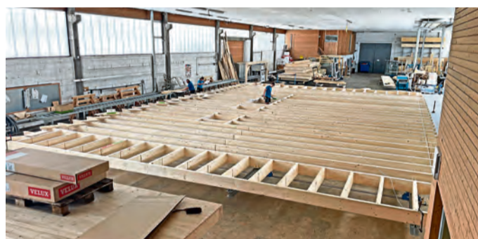
Die Werkhallen von JURA-HOLZBAU GmbH sind groß genug, dass alle Einzelelemente eines Hauses einschließlich Geschossdecken wie auf diesem Bild passgenau vorgefertigt werden können.
