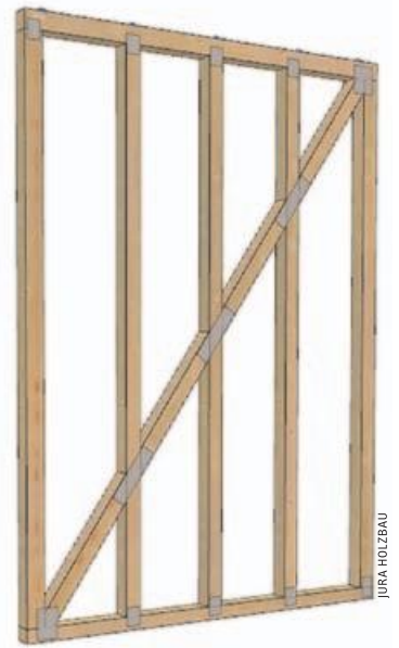
▲ Bei insgesamt 85 Bauteilen sorgen eingepresste Nagelplatten für stabile Verbindungen. Rund 40 t Holz und rund 1 t Stahl wurden hier verbaut
