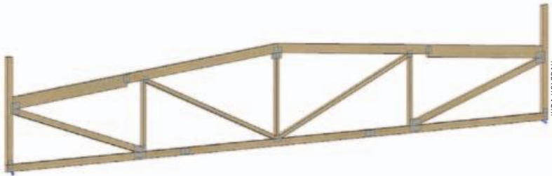
▲ Mit Nagelplattenbinder-Konstruktionen lassen sich Dachtragwerke mit hohen Spannweiten sowie stabile Wände realisieren
