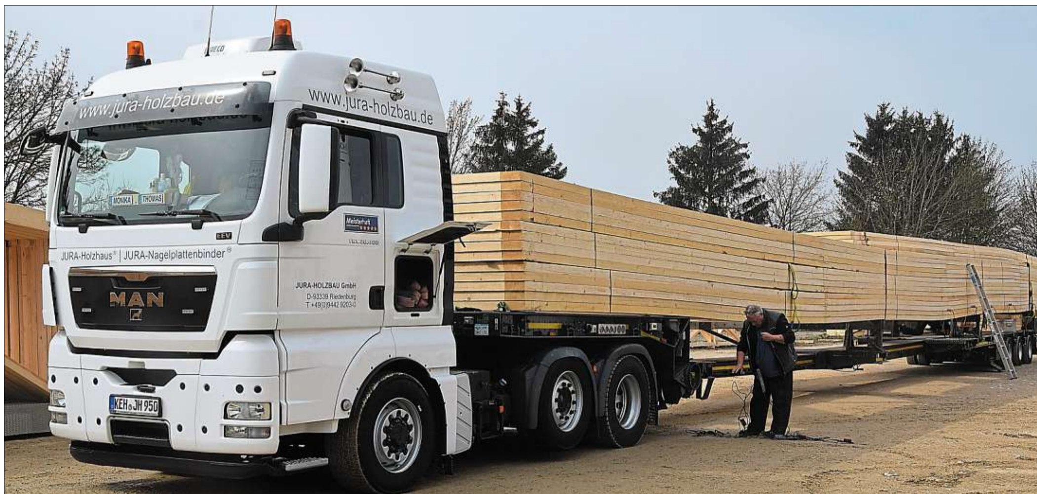
Flexible Sonderanfertigung: Der Auflieger des Schwertransporters lässt sich von 13 auf rund 27 Meter verlängern. Insgesamt misst der beladene Lkw dieses Mal 37 Meter.
